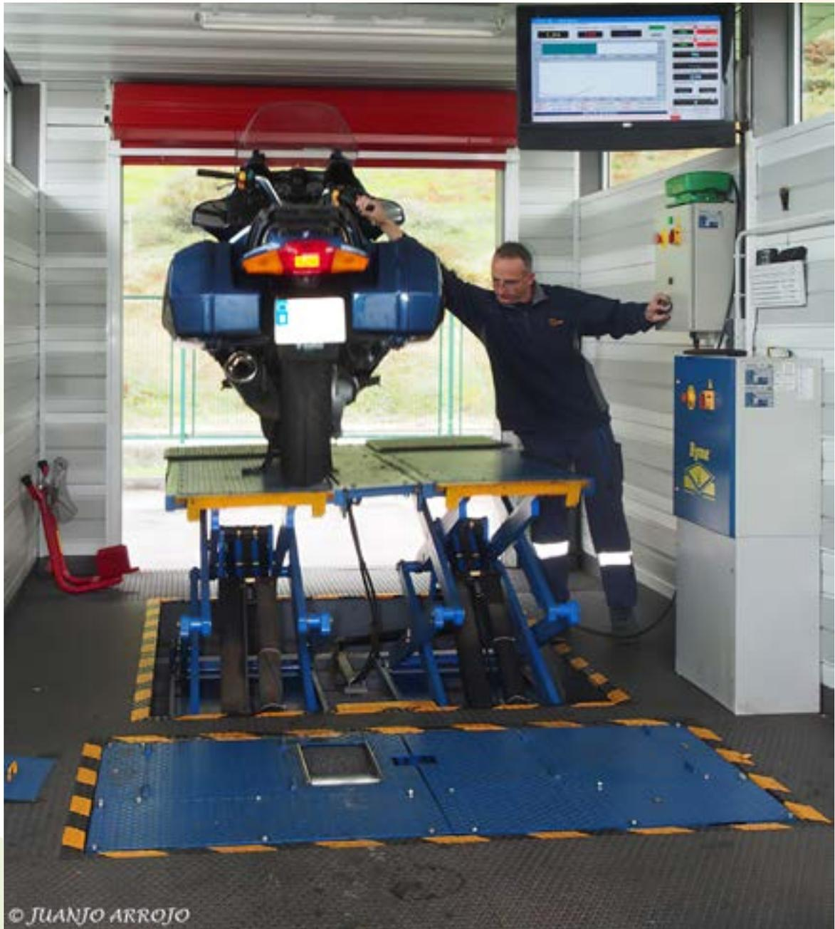
Ligne spéciale pour motos PTI - Photo des installations réalisée avec la permission d'Ivvasa
