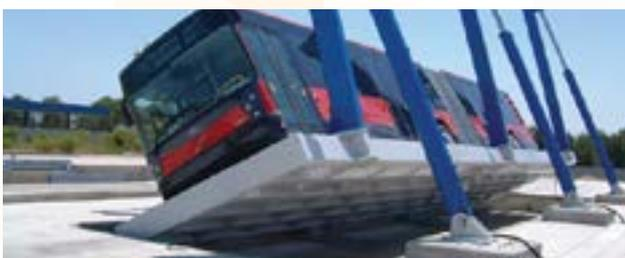
Essai de résistance de superstructure d'un bus © IDIADA-Spain
