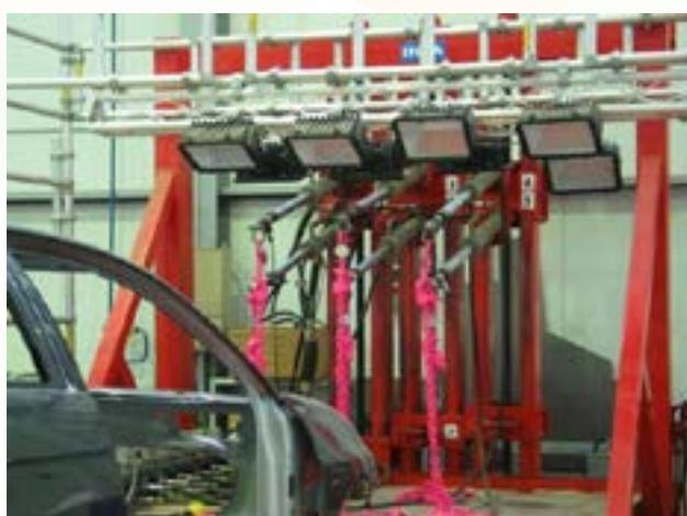
Machine de test d'ancrage des sièges ©INTA-Spain
